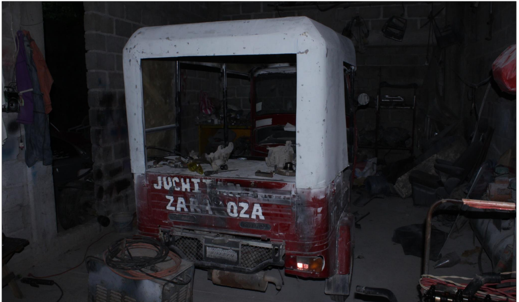
Colocación de la fibra de vidrio que sirve de cubierta y protección del acervo bibliográfico en el interior del mototaxi.
